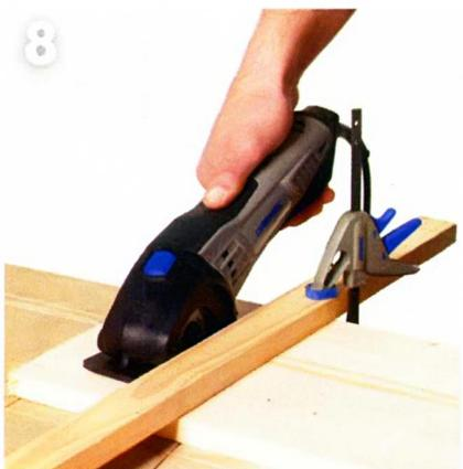
Из мебельного щита выкраивают полку и детали для короба, укрывающего провода, а из обрезков рейки — опоры для полки. Определив положение полки в шкафу, приклеивают опоры к стенкам шкафчика. Дав клею затвердеть, устанавливают полку.
