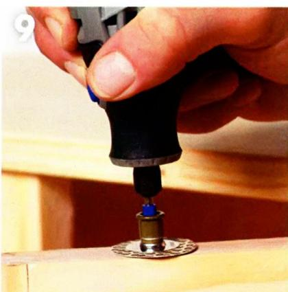
На кромки деталей шкафчика наносят порозаполнитель для древесины. Когда он высохнет, излишки удаляют шлифованием, например, при помощи Dremel 3000 с абразивным кругом EZ SpeedClic SC411.
