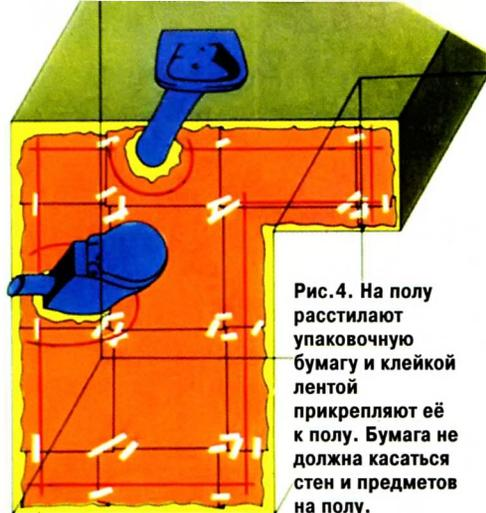
**Рис.4.** На полу расстилают упаковочную бумагу и клейкой лентой прикрепляют её к полу. Бумага не должна касаться стен и предметов на полу.
