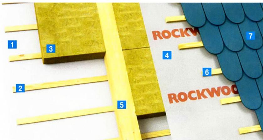
**Рис 1.** При укладке утеплителя руководствовались схемой производителя, но немного отступили от неё в части способа крепления пароизоляции, которую подложили непосредственно под утеплитель.
