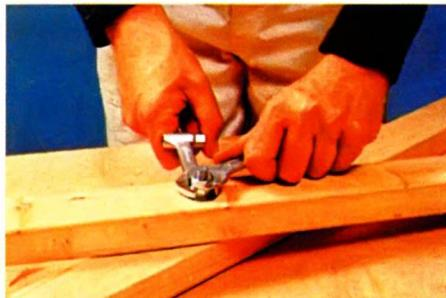
С наружной стороны ножки вставляют болт с полукруглой головкой с «усом». Затем на болт надевают шайбу, а после этого — вторую ногу. Сверху надевают ещё одну шайбу и накручивают две гайки.
