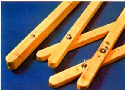
Складные козлы имеют три пары ног. Осью шарнира и одновременно деталью, соединяющей ножки, служит болт М10 с гайкой. Шайбы делают соединение подвижным, несмотря на сильную затяжку гаек.
