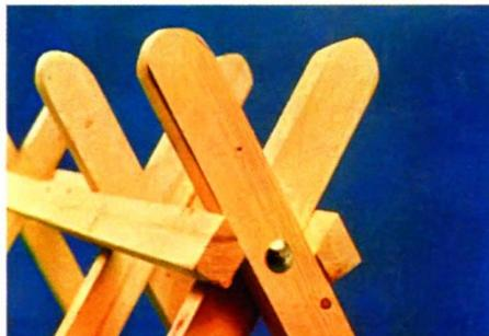
Так выглядят собранные козлы. Кромки упорных брусков немного скшивают, чтобы ножки ложились на всю поверхность кромки, не заминая рёбра.
