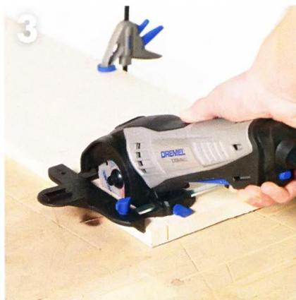
Для выполнения некоторых операций на пилу понадобится установить штатный параллельный упор DSM. Он позволяет опилить заготовку параллельно кромке на нужном расстоянии от неё.
