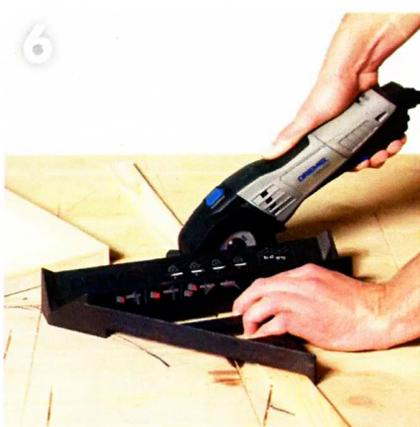
Используя упор DSM840 к пиле Dremel DSM20, от рейки сечением 36 × 4 мм отпиливают детали для обрамления дверок шкафчика. Их приклеивают с лицевой стороны каждой дверки, чтобы сделать их похожими на филёнчатые. В данном случае снова используют пистолет Dremel с клеевым стержнем.
