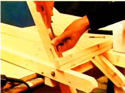
Строганные бруски-перемычки связывают три пары ножек в единую конструкцию и одновременно являются упорами, которые ограничивают раствор ножек козлов. Бруски крепят к ножкам шурупами.
