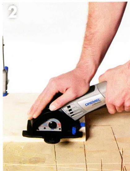
Чтобы не испортить крышку верстака (или стола), укладывают на него большой ровный кусок толстой фанеры. Это позволит без опасений выкраивать компактной дисковой пилой Dremel® DSM20™ заготовки из мебельных щитов и реек в соответствии с проектом. При раскрое заготовки надёжно фиксируют струбцинами.
