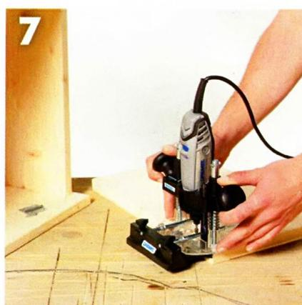
Определив положение дверных петель, выполняют разметку и делают выборки для каждой петли в стенках и дверках шкафчика. При обработке используют фрезы 650 и 654 для Dremel 3000. Прикрепив петли к дверкам, поочередно прикладывают дверки к шкафчику и прикручивают петли шурупами.
